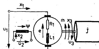
Fig. I.5. Motor electric de c.c. cu excitație separată.
