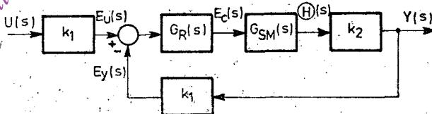
Fig. I.11. Schema bloc structurală a sistemului automat de urmărire.
