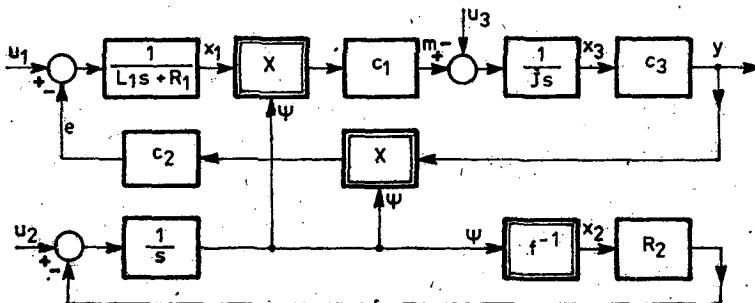
Fig. I.6. Schema bloc structurală a motorului electric de c.c.
