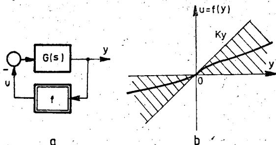
Fig. III.29. a – Structura sistemului automat neliniar pentru abordarea stabilității absolute;
