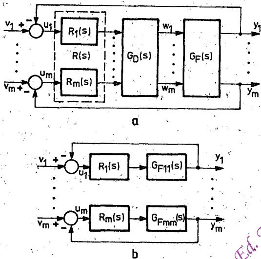
Fig. IV.17. Schema bloc structurală a unui sistem automat multivarabil decuplat:
