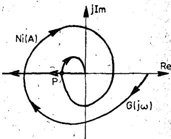
Fig. III.9. „Defecțiunea” regulii lui Loeb.
