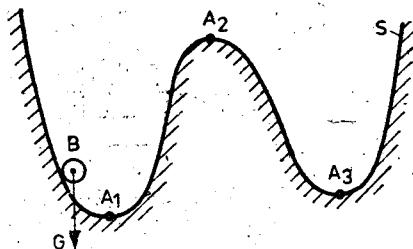
Fig. I.15. Sistem cu trei puncte de echilibru.
