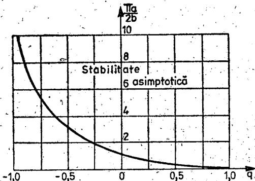
Fig. III. 11. Domeniu parametric de stabilitate asimptotică la exemplul 1.5.
