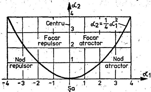
Fig. III.19. Clasificarea în planul  $(\alpha_1, \alpha_2)$  a tipurilor de puncte de echilibru ale părții liniare (2.22) a sistemului (2.21).
