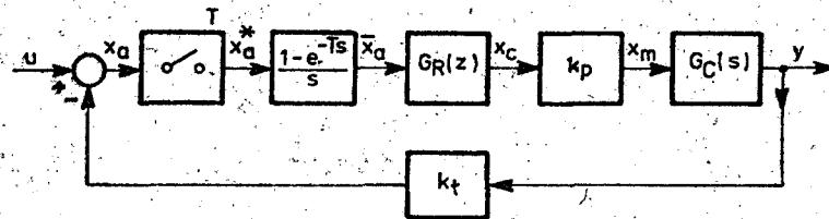
Fig. I.14. Schema bloc structurală a sistemului de reglare automată a temperaturii.
