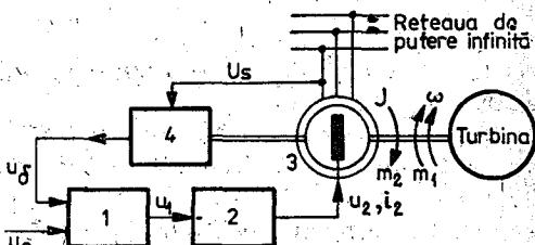
Fig. II.15. Schema bloc funcțională a sistemului de reglare automată a unghiului polar al unui generator sincron:
