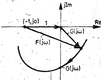
Fig. II.25. Determinarea lui  $F(j\omega)$  din  $G(j\omega)$ .
