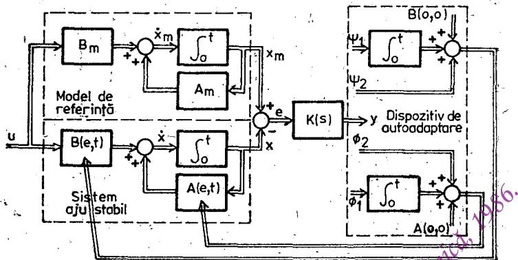
Fig. IV.20. Structura sistemului autoadaptiv hiperstabil.
