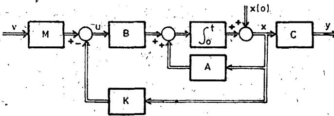
Fig. IV.14. Structura sistemului cu reacție după stare (ecuațiile (2.1)–(2.3)).
