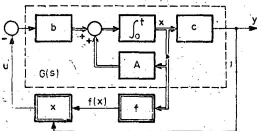
Fig. III.32. Structura sistemului automat neliniar pentru teorema 21 (criteriul cercului).
